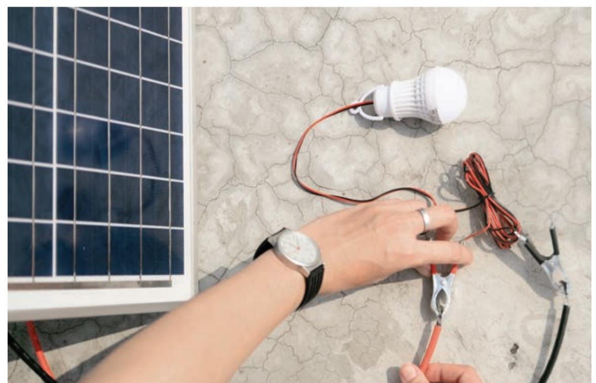
2 ต่อสายไฟ +/- ของแผง เข้ากับหลอดไฟ
